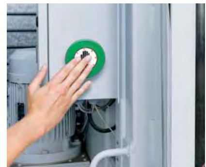
Activación de una operación mientras la mano toque el pulsador.
