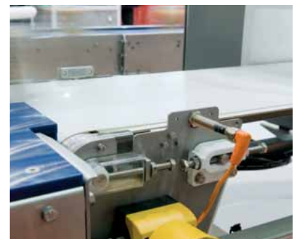
Detección efectiva de material sobre una cinta transportadora.
