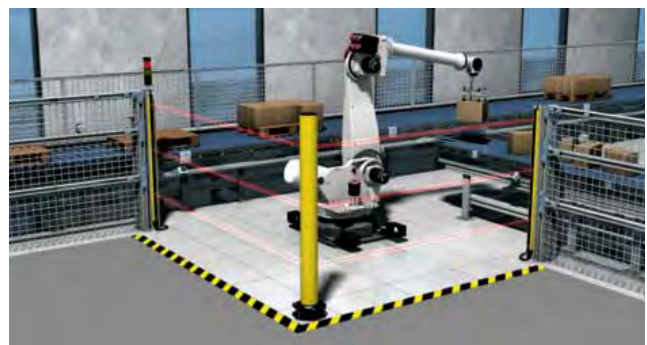
Las barreras fotoeléctricas de seguridad protegen el campo de trabajo de los robots.
