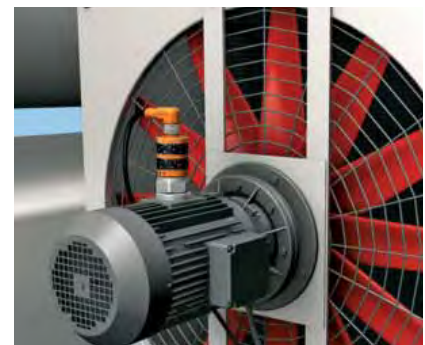
Supervisión de la vibración general de piezas rotativas (ventiladores, centrifugadoras, etc.).
