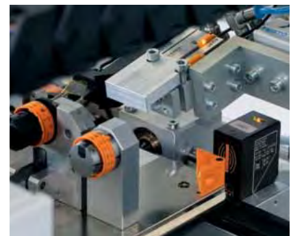
Detección efectiva de los finales de carrera también con los cilindros cortos.
