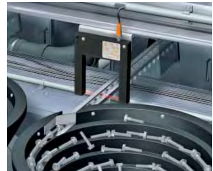
Detección precisa de tornillos en sistemas de alimentación.
