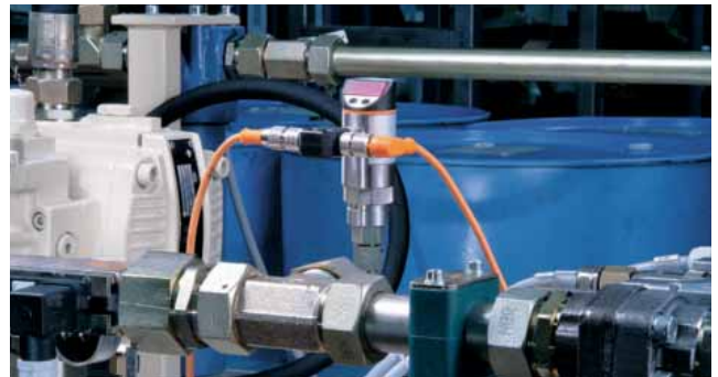
Medición de la presión diferencial en la supervisión de filtros.
