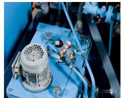
Medición simultánea de nivel y temperatura en unidades compactas.
